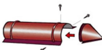
Планки конька бывают плоские или круглые. Монтаж планки конька круглого начинается с крепления саморезами или заклепками по ее торцам плоских или конусных заглушек (в соответствии с формой крыши). Для планки конька плоского заглушек не требуется.
