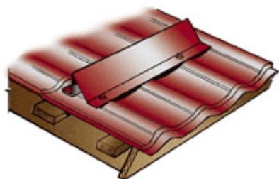
В качестве экономичного варианта решения указанной проблемы можно применить планку снегозадержателя, которая крепится через волну коньковыми саморезами (80 мм) совместно с планкой усиливающей к обрешетке, нижний край снегозадержателя крепится к металлической черепице обычными саморезами.
