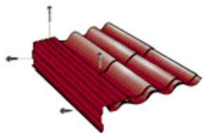
На торцы крыши устанавливают планки торцевые. Их закрепляют через 500-600 мм саморезами длиной 28 мм (сбоку) и 80 мм (сверху). Нахлест между планками — 50 мм, при необходимости планки подрезают.
