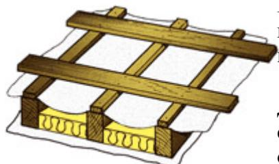
Рулоны гидроизоляции раскатывают по стропилам горизонтально, начиная от карниза с провисом 20 мм. Между полотнищами делается нахлест 150 мм.
