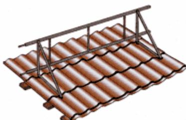
Для безопасного перемещения по кровле во время ее эксплуатации на уровне карниза крепится вертикальная решетка ограждения кровли ОК-h600x1860 (дл. 1,86 м). Обрешетка под нее выполняется сплошной.
