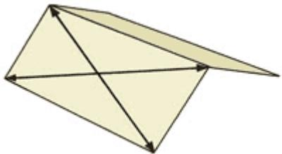
После установки стропил рекомендуется осуществить контрольный обмер скатов крыши, так как в процессе строительства возможны отклонения от проекта. Проверьте прямоугольность и плоскостность крыши, измерив диагонали скатов. Небольшие дефекты прямоугольности крыши (до 10 мм) можно скрыть с торцов с помощью доборных элементов.
