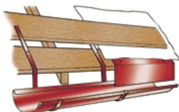
При монтаже водосточной системы круглого сечения вставьте и закрепите желоб в держателях, заведя заднюю кромку желоба в выступ-фиксатор держателя. Прикрепите к обрешетке планку карнизную: ее нижний край должен перекрывать край желоба. Подкровельную гидроизоляционную пленку выведите поверх планки карнизной, чтобы конденсат стекал с пленки в желоб.
