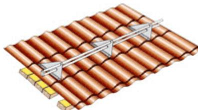
Во избежание лавинного схода снега с крыши в весенне время предусматривают установку надежного трубчатого снегозадержателя СЗТ-h158x3000 (дл. 3 м). Обрешетка под ним выполняется сплошной. Расстояние между опорными кронштейнами ок. 1000 мм, а расстояние до концов снегозадержателя ок. 500 мм. Монтаж снегозадержателя
