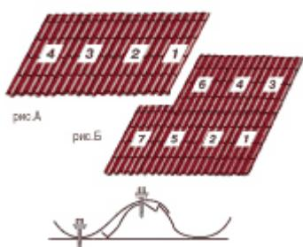
Первый лист металличерепицы выравнивается по торцу крыши и закрепляется одним саморезом у конька. При этом вынос листа относительно карниза составляет 40 мм (см. рис.А). Второй лист укладывается внахлест на первый, если монтаж кровли ведется справа налево или край второго листа подкладывается под край первого, если монтаж производится слева направо. Листы соединяются саморезами в верхнюю часть перехлеста так, чтобы они не были прикручены
