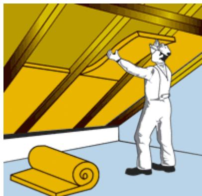
После установки гидроизоляции обеспечивается возможность одновременного проведения работ снаружи по устройству кровельного покрытия и теплозвукоизоляционных работ изнутри помещения. Маты или плиты теплоизоляции устанавливаются враспор между стропилами, оставляя 20 мм вентиляционный зазор до гидроизоляционной пленки типа «ЮТАФОЛ Д СИЛЬВЕР» или «ЮТАКОН», в противном случае пленка потеряет свои свойства. Между утеплителем и пленками типа «ТАЙВЕК» или «ЮТАВЕК» зазор не нужен.
