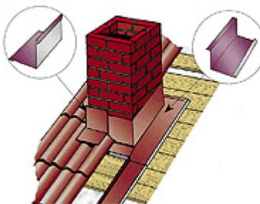
Для герметичного примыкания металличерепичной кровли к печным трубам или стенам на скате крыши организуют внутренний фартук. Для его изготовления используют планки примыкания нижние. Планку прикладывают к стенкам трубы и отмечают верхнюю кромку планки на стенке. Затем по намеченной линии болгаркой пробивают штробу. Когда штробление завершено, пыль убирают, а штробу промывают водой.
