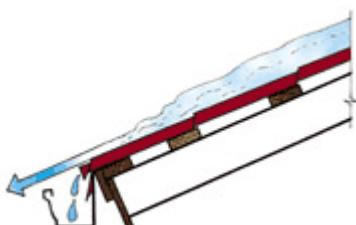
Установите держатели желоба на нижней доске обрешетки в соответствии с инструкцией по монтажу водосточной системы.
