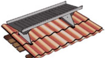
Для доступа к трубам, антеннам и т. п. на крыше устанавливаются переходные мостики ПМ-355x1100 дл. 1,1 м (на сплошную обрешетку). Крепление опорных кронштейнов мостика к кровле производится аналогично креплению кровельного ограждения. Регулировка наклона платформы (до 50°) относительно кровли осуществляется подбором соответствующих отверстий в нижнем и верхнем кронштейнах и их фиксацией болтами M8x20 (по два на каждой стороне).
