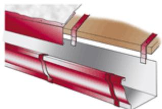
При монтаже водосточной системы прямоугольного сечения вставьте и закрепите желоб в держателях. Прикрепите к обрешетке планку карнизную: ее нижний край должен перекрывать край желоба. Подкровельную гидроизоляционную пленку выведите поверх планки карнизной, чтобы конденсат стекал с пленки в желоб.
