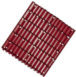
Низ листа металличерепицы прикрепляется саморезами в подошву волны через волну. Следующие ряды саморезов вкручиваются в шахматном порядке через одну волну. Боковой нахлест листов металличерепицы скрепляется саморезами по гребню каждой волны. Количество саморезов — 6-8 штук на квадратный метр.
