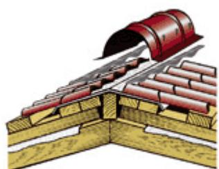
На конек укладывают фигурный уплотнитель с предварительно освобожденными вентиляционными отверстиями, на который монтируют планку конька плоского или круглого, закрепляемую коньковыми саморезами (80 мм) через одну волну металличерепицы. Между планками конька делают нахлест 100 мм.
