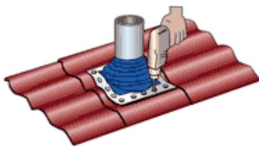
Срежьте верхушку антенного выхода до размера примерно на 20% меньше диаметра трубы, наденьте его на трубу. Придайте с помощью киянки основанию антенного выхода форму кровли. Промажьте стыки силиконовым герметиком и закрепите антенный выход саморезами к кровле.
