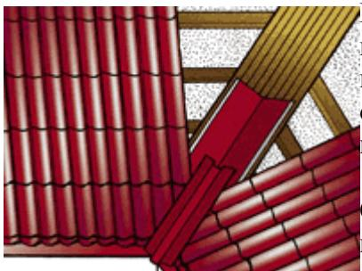
В месте внутреннего стыка скатов к сплошной обрешетке крепят саморезами планку ендовы нижней. Пристыковку планок делают нахлест около 100-150 мм (в зависимости от угла наклона крыши). Затем, предварительно размещенные и подрезанные, укладывают листы металличерепицы.
