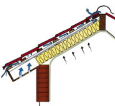
При суточном перепаде температур на нижней поверхности металлического листа образуется конденсат. Кроме того, испарения, поднимающиеся из внутренних помещений дома, в холодном воздухе подкровельного пространства превращаются в воду. Избыточная влажность приводит к намоканию утеплителя и, следовательно, снижению его теплотехнических характеристик, промерзанию крыши и образованию наледей на кровельном покрытии, гниению стропил и обрешетки, появлению плесени, порче внутренней отделки помещений.
