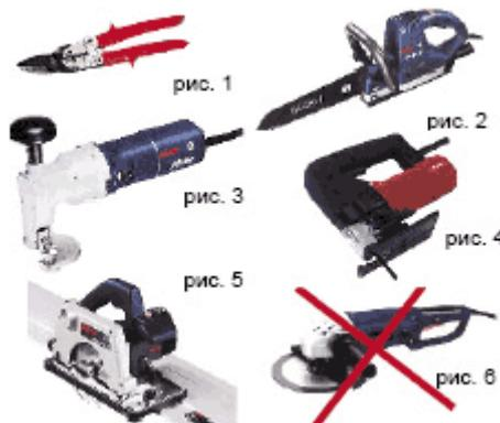
Для резки металлических листов можно использовать ручные ножницы по металлу (рис. 1), ножовку с мелкими зубьями (рис. 2), электрические высечные ножницы (рис. 3), электролобзик (рис. 4), дисковую пилу с твердосплавными зубьями (рис. 5). После резки листов сметите металлические опилки, иначе они поржавеют и испортят покрытие.
