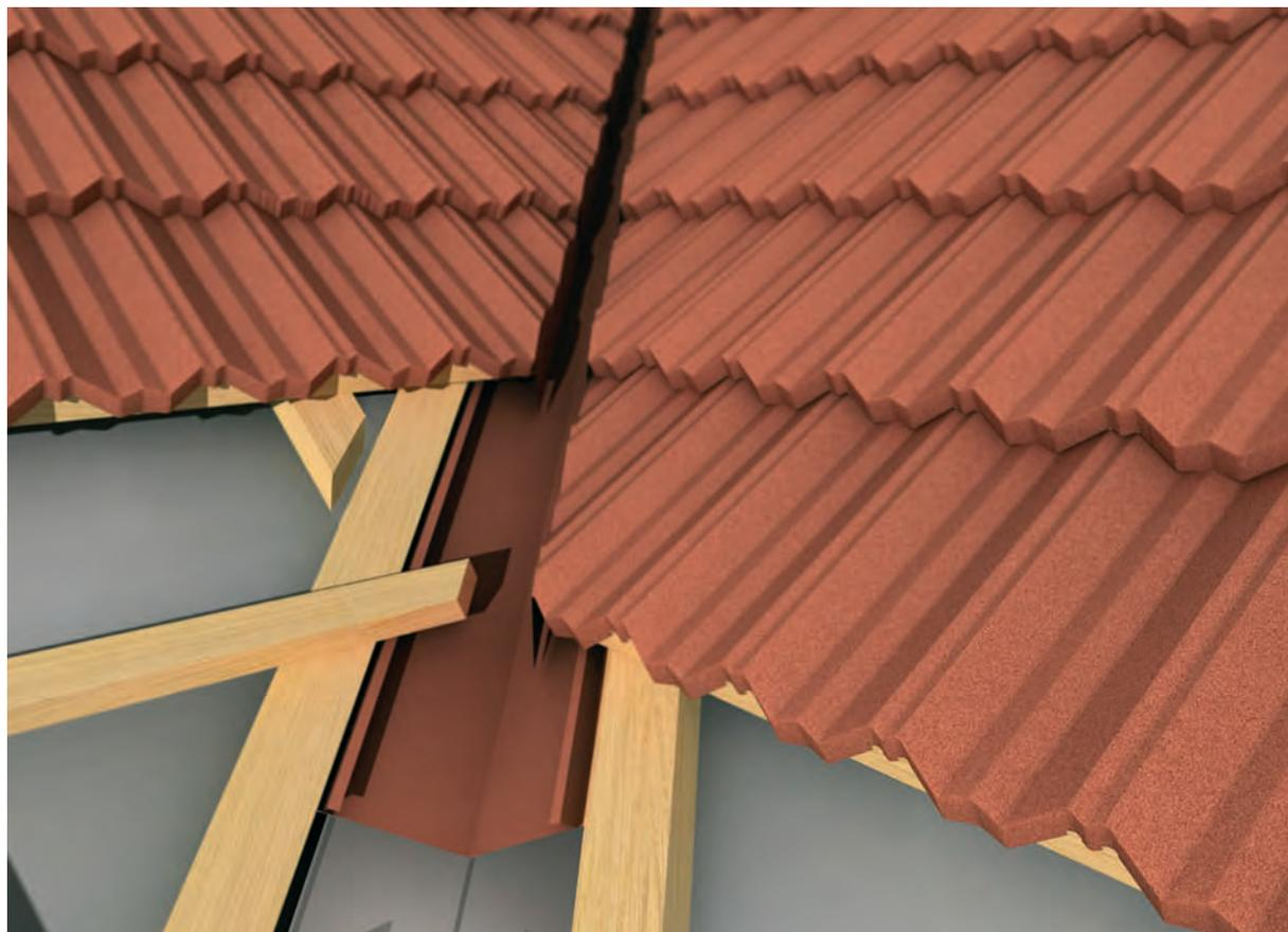
Особое внимание требуется в местах, где кровля примыкает к вертикальной стене. Обязательно подгибаются края черепицы под примыкание. Для замеров, резки и сгибания черепицы следуйте процедуре, описанной для козуха ветровой доски (см. стр. 34; КОЖУХ ВЕТРОВОЙ ДОСКИ/ Резка и сгибание кровельного листа).
